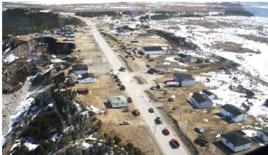
Figure 2.45 La ville de Daniel's Harbour après le glissement de terrain de 2007. La zone de glissement de terrain est visible en haut à gauche de la photo. La route a été abandonnée et les maisons situées à gauche de la route ont été retirées. La construction d'une nouvelle route est visible à droite des maisons (gouvernement de Terre-Neuve-et-Labrador).
