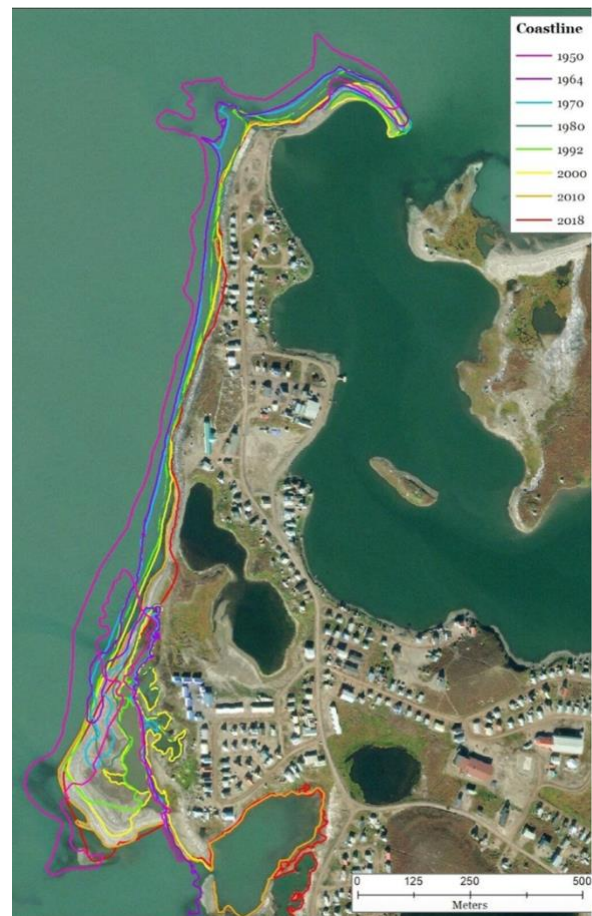
Figure 2.43 Image aérienne de Tuktoyaktuk en 2010 montrant le recul du trait de côte entre 1950 et 2018 (Future Tuktoyaktuk, images fournies par RNCAN 264 )
