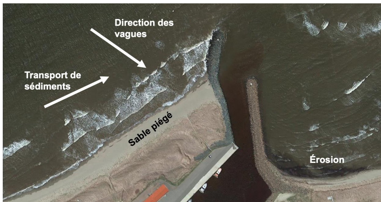
Figure 1.3 Accrétion (sable piégé) et érosion près des ouvrages perpendiculaires au rivage. Les structures artificielles peuvent interférer avec les processus naturels d'écoulement et de sédimentation et avoir des conséquences inattendues plus loin sur la côte (Google Earth, 2022)
